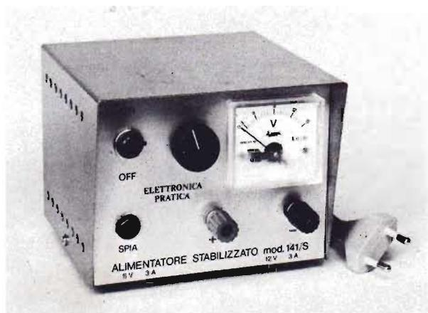
Di facilissima costruzione e di grande utilità nel laboratorio dilettantistico, l'alimentatore stabilizzato è dotato di una moderna protezione elettronica, che permette di tollerare ogni eventuale errore d'impiego del dispositivo, perché la massima corrente d'uscita viene limitata automaticamente in modo da proteggere l'alimentatore da eventuali cortocircuiti.
